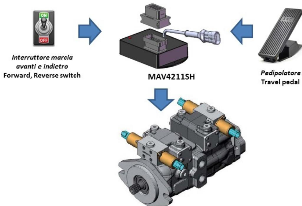
*Modalità 4 = Controllo di pressione e portata di una pompa in circuito aperto*
