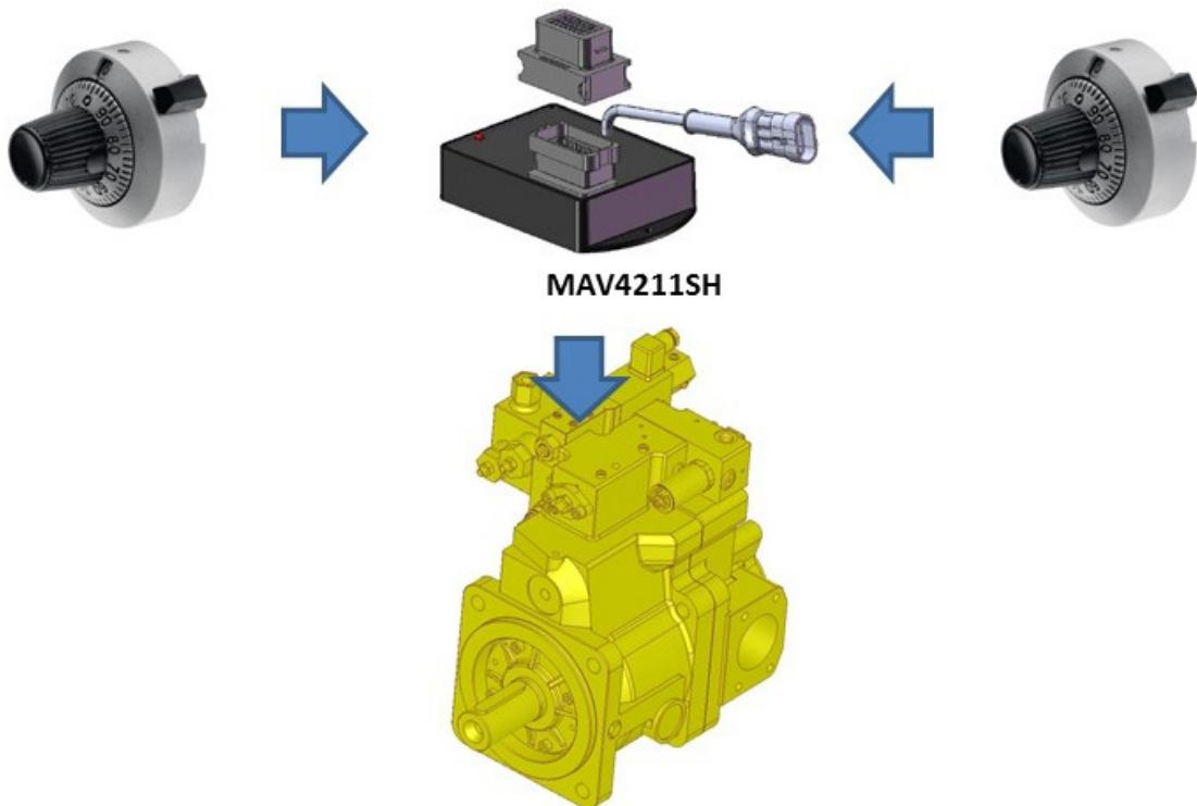
*Modalità 5 = Controllo di una pompa e di uno o due motori in sequenza*
