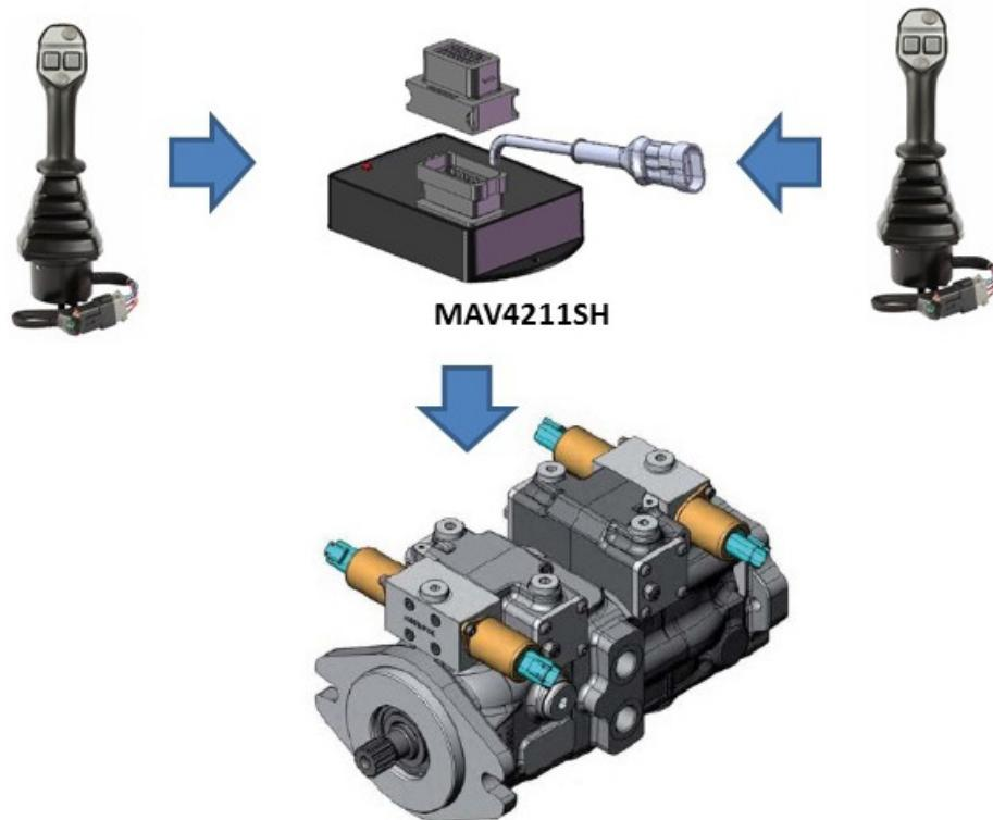
*Modalità 3 = Controllo di due pompe in circuito chiuso in collegamento tandem*
